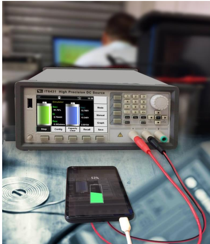
图一 手机整机快充测试方法示意图
